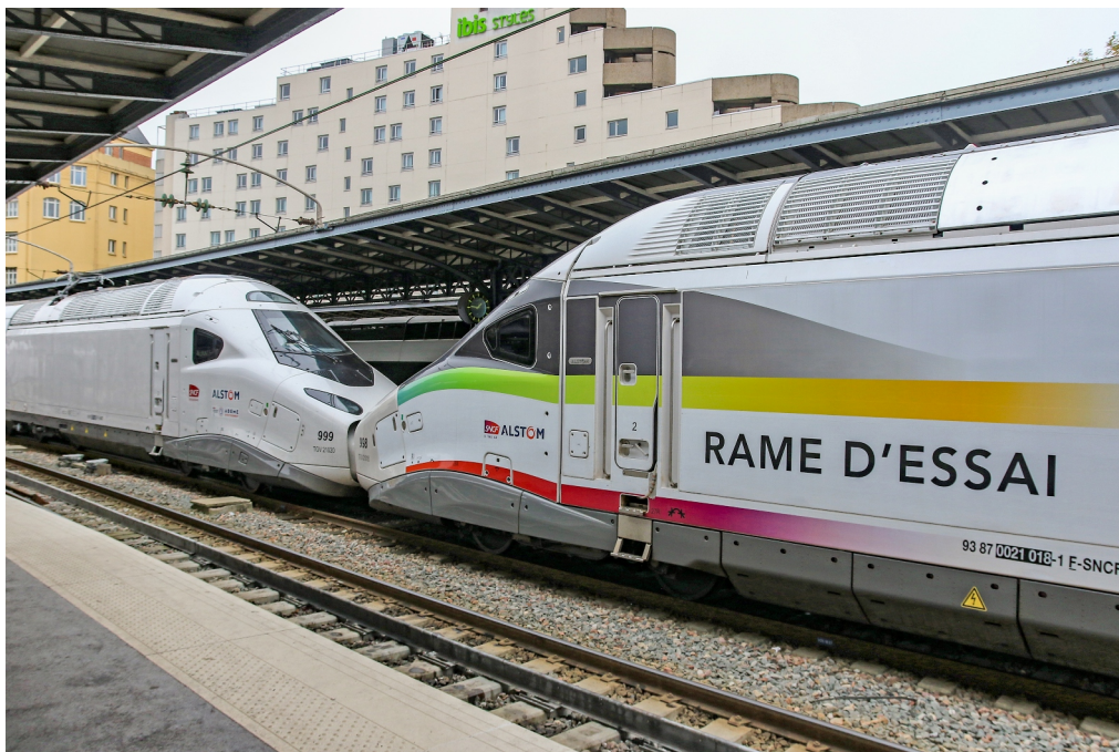
Les TGV M de présérie n°998 et 999 assurent des essais en unité multiple (UM2) depuis le 21 octobre 2024. Les rames sont photographiées en gare de l'Est, le 10 novembre 2024, lors d'un rebroussement pour regagner le Technicentre Est Européen (TSEE).
